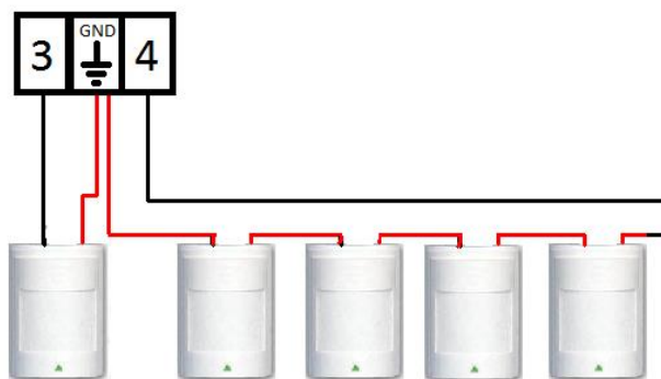
Obrázek 4: Zapojení externích detektorů typu NC.
