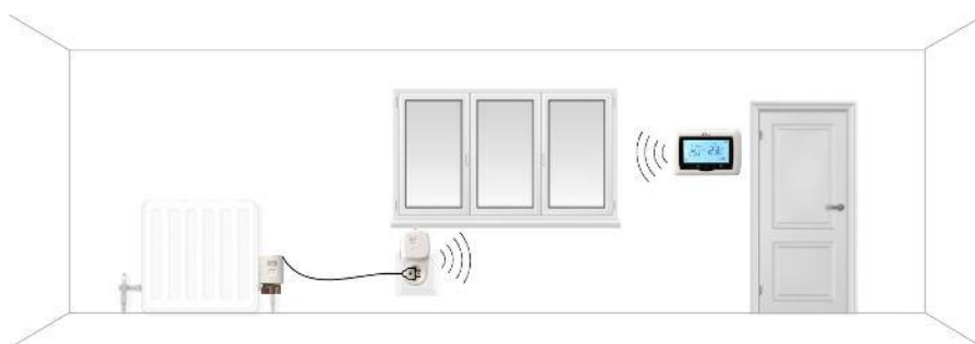
Obrázek 3: Zapojení termostatu s topným tělesem.
