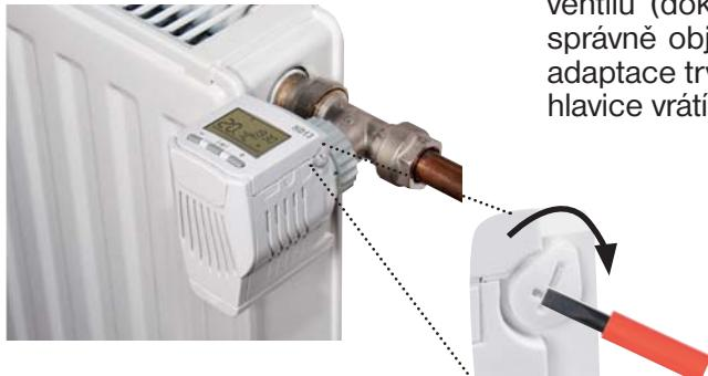
Po nasazení hlavice na ventil se na displeji objeví nápis "Ad:AP" a hlavice se automaticky přizpůsobí ventilu (dokud neproběhne adaptace správně objevuje se i nápis Err). Tato adaptace trvá cca 1min., poté se hlavice vrátí do normálního režimu.
