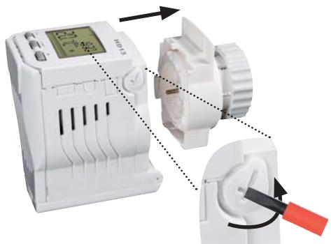
4.4 Uchopte těleso hlavice displejem směrem nahoru, zkontrolujte zda páčka západky směruje také vzhůru. Potom těleso naklapněte z vrchu dolů na ventil s převodovou částí.
