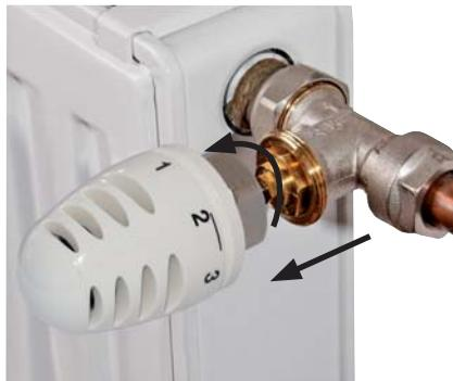
4.3 Uchopte převodovou část hlavice HD13, vyšrouubujte ozubené kolečko proti směru hodinových ručiček až na doraz. Nasadte převodovou část s maticí na ventil a rukou dotáhněte matici na ventil (NEPOUŽÍVEJTE ŽÁDNÉ NÁSTROJE!).
