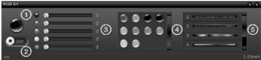
Obr. 2 Okno s prvky pro ovládání barev RGBW modulu Fibaro
