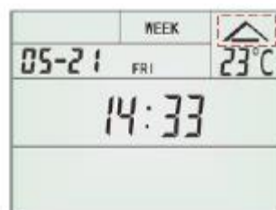
Napájeno AC/DC, GSM signál v pořádku
